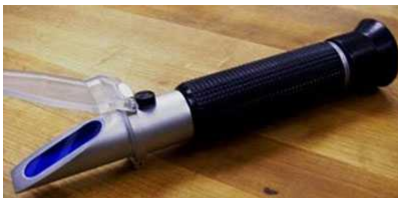
ภาพที่ 1.1 เครื่องมือวัดค่าความเค็มของน้ำ (reflecto-salinometer)
